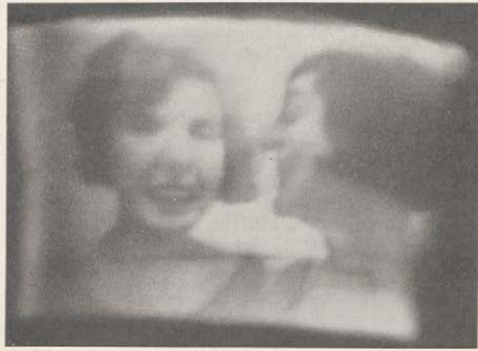
Abb. 17. Neuere Bild von der Innenseite der Braunschens Röhre aufgenommen
